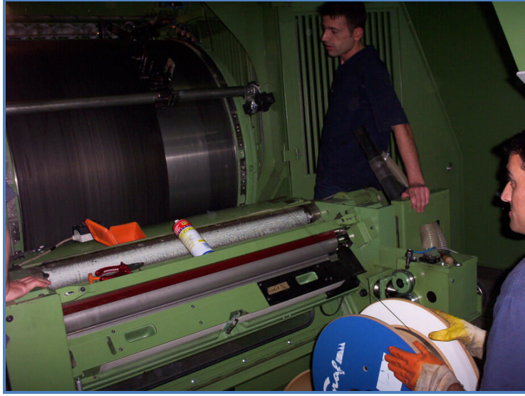
Resim 1.3: Tarak makinesinde garnitür tellerinin değiştirilmesi
