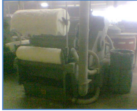
Resim 2.1: Vatka beslemeli tarak makinesi
